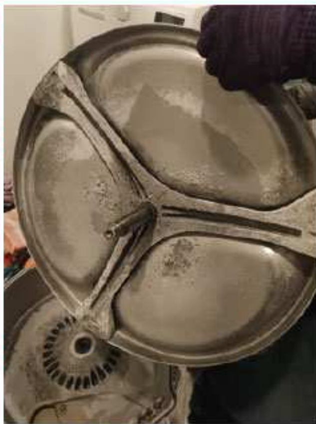
ドラムの底、ケースの底が汚れてます
